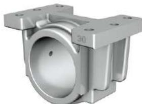
Alloggiamento leggero in esecuzione chiusa. Disponibile nelle taglie da 8 mm a 80 mm per manicotti standard. Facile da fissare tramite la superficie superiore o inferiore, con un lato di riferimento definito per l'allineamento lineare. Realizzato per il fissaggio dei manicotti tramite il raccordo di lubrificazione, ad eccezione della taglia 8 mm.
