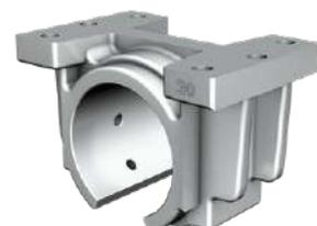
Alloggiamento leggero in esecuzione aperta. Disponibile nelle taglie da 12 mm a 80 mm per manicotti standard. Facile da fissare tramite la superficie superiore o inferiore, con un lato di riferimento definito per l'allineamento lineare. Realizzato per il fissaggio dei manicotti tramite il raccordo di lubrificazione.
