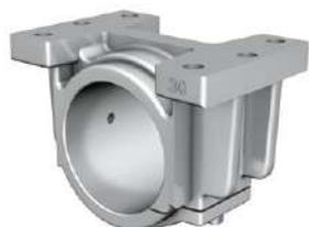
Alloggiamento leggero in esecuzione con taglio longitudinale per la regolazione del gioco. Disponibile nelle taglie da 8 mm a 80 mm per manicotti standard. Facile da fissare tramite la superficie superiore o inferiore, con un lato di riferimento definito per l'allineamento lineare. Realizzato per il fissaggio dei manicotti tramite il raccordo di lubrificazione, ad eccezione della taglia 8 mm.
