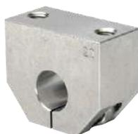
I supporti di estremità LSHS e LSNS sono realizzati in alluminio e fissano saldamente l'albero. I supporti LSHS sono progettati per essere utilizzati con le unità della gamma compatta Ewellix, mentre i supporti LSNS sono realizzati per adattarsi al design delle unità della gamma standard. Possono essere avvitati da entrambi i lati alla superficie di montaggio e sono disponibili da 12 mm a 50 mm.
