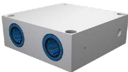
Le unità quadro LQC costituiscono da sole delle vere e proprie slitte lineari pronte all'impiego con alberi Ewellix e supporti di estremità. Sono composte da un alloggiamento in alluminio monoblocco con due file parallele ognuna con due manicotti a sfere. Le unità quadro possono essere fissate a una superficie di supporto da entrambi i lati utilizzando idonee viti e sono disponibili in esecuzione aperta e chiusa.
