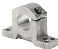
LSCS sono supporti di estremità pressofusi leggeri da utilizzare per unità compatte o standard. Questi supporti fissano saldamente la posizione dell'albero. Possono essere avvitati dall'alto o dal basso e hanno un lato di riferimento definito per l'allineamento lineare. I supporti di estremità LSCS sono disponibili per diametri albero da 8 mm a 80 mm.
