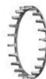
Fig. 7. Gabbia in ottone fresata, di tipo a pettine, costituita da due pezzi, guidata sull'anello interno.
