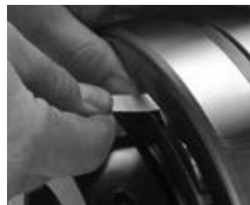
Fig. 18. Misurazione del GRI prima dell'installazione.
