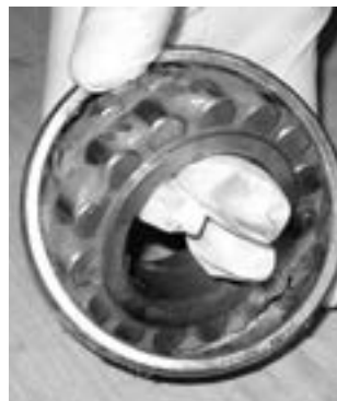
Fig. 21. Il riempimento con grasso può essere facilmente effettuato anche a mano.
