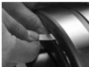
Fig. 14. Misurare il GRI prima dell'installazione.
