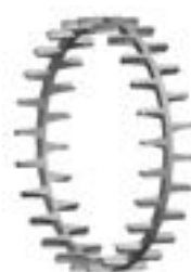
Fig. 5. Gabbia in ottone fresata di tipo a pettine, costituita da un unico pezzo, con guida sui rulli.
