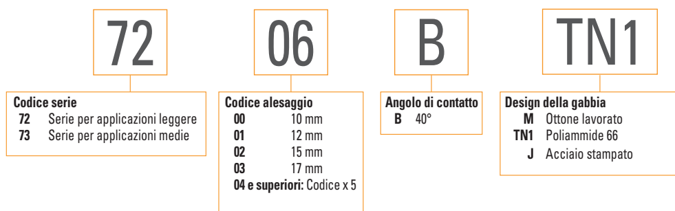
Fig. 15. Codifica dei cuscinetti a sfere a contatto obliquo standard a singola fila:
