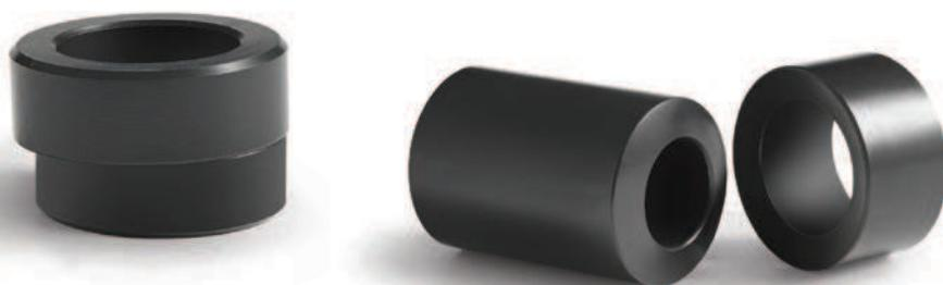
Le ralle sferiche di SKF sono state progettate per creare un piano parallelo di precisione tra testa del bullone e faccia della ghiera. Questa ralla sferica si regola automaticamente per compensare gli scostamenti angolari ed evitare il piegamento del bullone.
