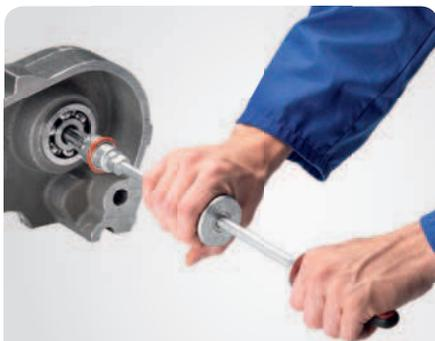
L'estrattore a battente, con design ergonomico per aumentare la sicurezza degli operatori, consente di applicare elevate forze di impatto.
