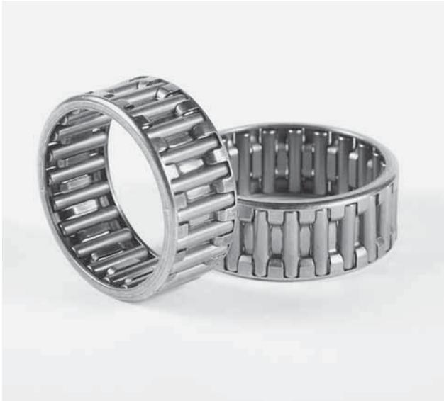
Le gabbie radiali a rullini sono in acciaio e disegnate per trattenere i rullini sia verso l'interno che verso l'esterno. L'esecuzione della gabbia garantisce la massima resistenza, in funzione dei carichi elevati tipici dei cuscinetti a rullini.
