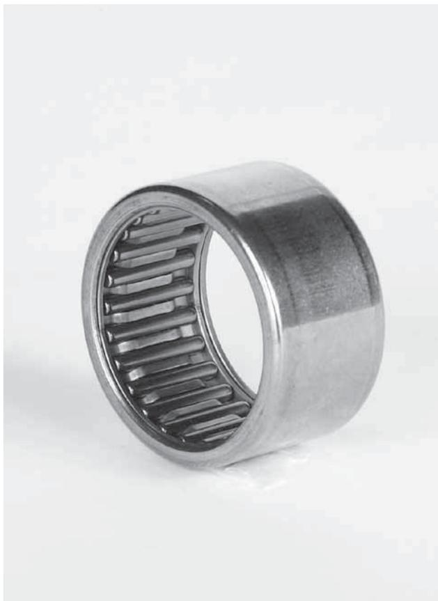
Gli astucci a rullini sono costituiti da un anello esterno sottile trattato, ottenuto per imbutitura di una lamiera d'acciaio calibrata. Possono essere provvisti sia di una corona di rullini accostati ritenuti alle loro estremità, sia di una gabbia a rullini ritenuta lateralmente.
