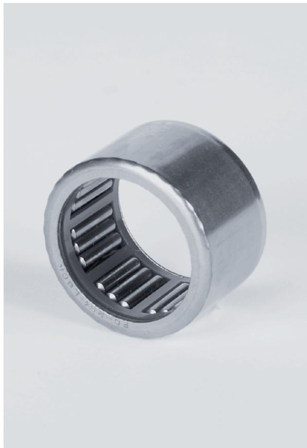
Le ruote libere ad astuccio trasmettono la coppia tra l'albero e l'alloggiamento in una direzione e ruotano liberamente nella direzione opposta. Quando trasmettono la coppia, l'elemento motore può essere rappresentato sia dall'albero sia dall'alloggiamento. Vengono prevalentemente utilizzate per avanzamenti intermittenti, con funzioni di antiritorno o come giunti di avviamento.
