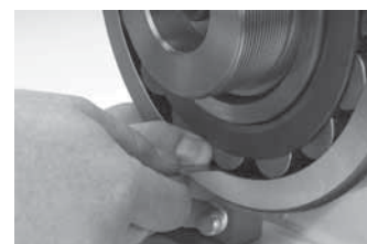
Dopo il montaggio, verificare il GRI in corrispondenza del rullo non caricato.
